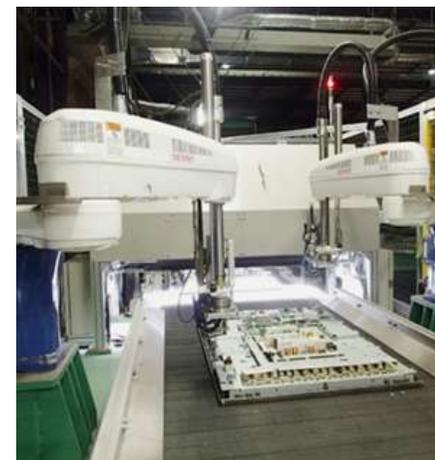
自動ねじ外し装置「ねじトラッカー®」の一例
