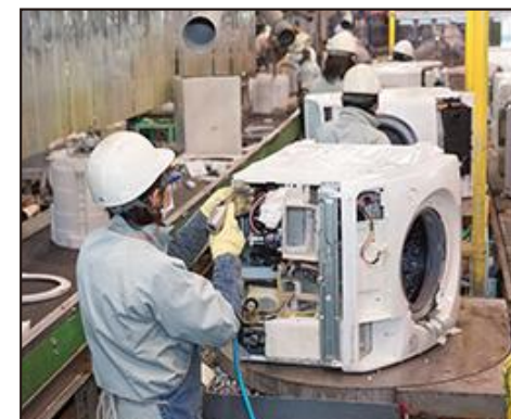
洗濯機の例：モーター、プリント基板、洗濯槽を手作業で回収します
