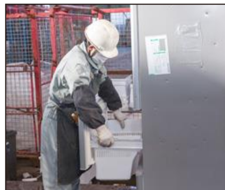
冷蔵庫の例：野菜ケース・ドアパッキンなどのプラスチック部品、コンプレッサーを手作業で回収します
