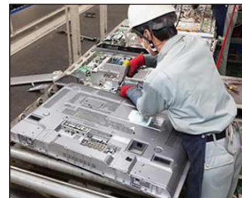
テレビの例：液晶パネル、プリント基板を手作業で回収します
