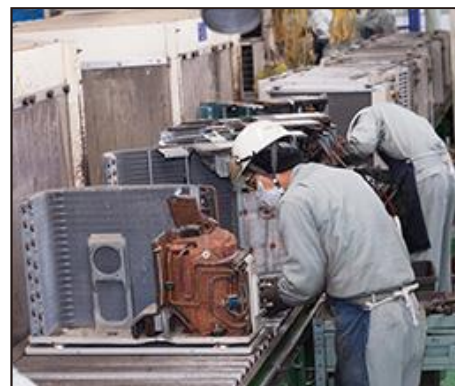
エアコンの例：コンプレッサー、モーター、熱交換器、プリント基板を手作業で回収します
