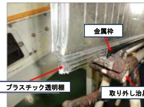
プラスチック透明棚の端部突起部を折ることで金属製部品の容易にスライドして取り外せる構造の一例
