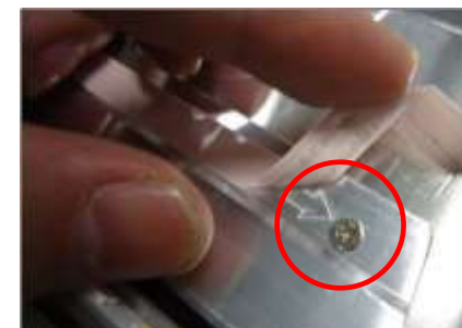
ねじの上に配線を引き回した一例
